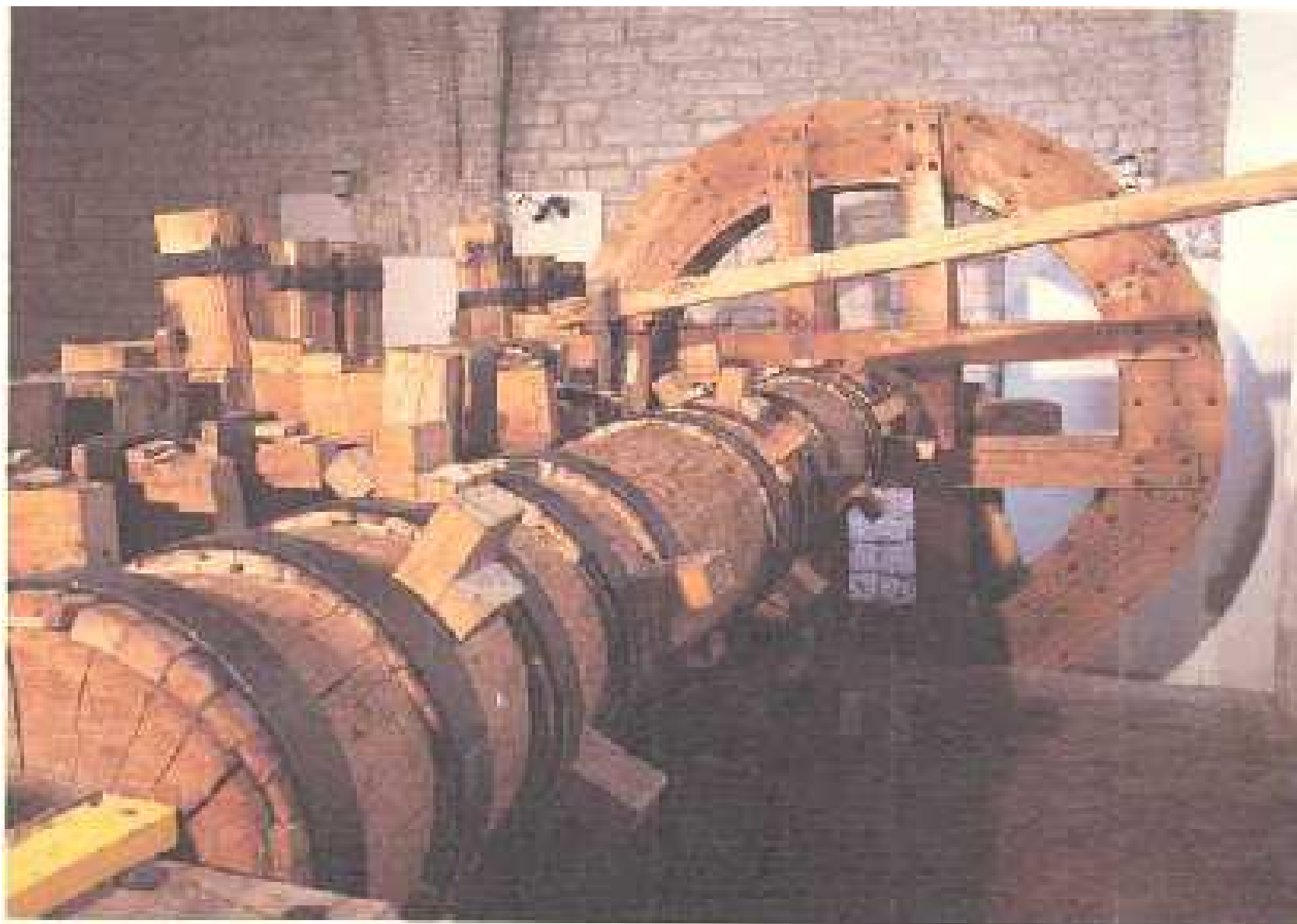
Pila a magli multiple, parte barattica ed albero di "gualchiera"
